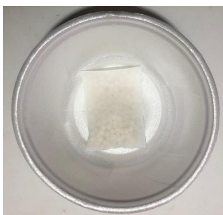
FIGURA 9. Sachê de tecido-não-tecido (TNT) preenchido com esferas de alginato de sódio disposto no fundo da embalagem de poliestireno expandido.
