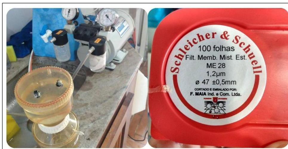
**Figura 08.** Bomba utilizada na filtragem da água marinha (esquerda) e filtro utilizado na bomba (direita) (Fotos: Hayla Viveiros).
