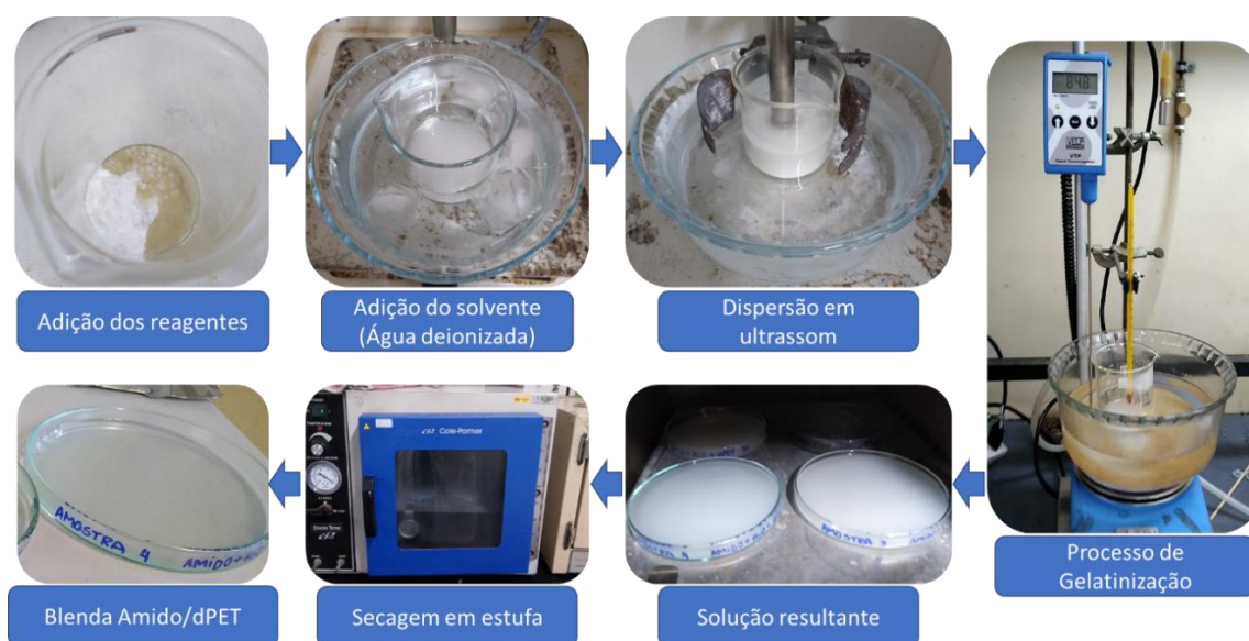
Figura 12 – Diagrama do processo de preparação das blendas à base de amido e dPET.
