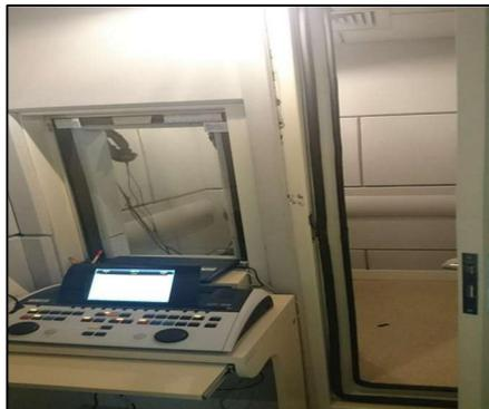
Figura 4 – Audiômetro AC-40 dentro da cabina acústica
