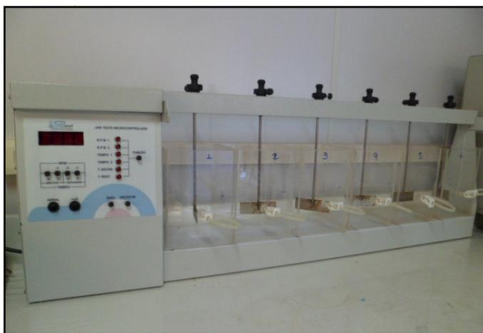
Figura 3: Equipamento de *Jar Test* utilizado nos ensaios.
