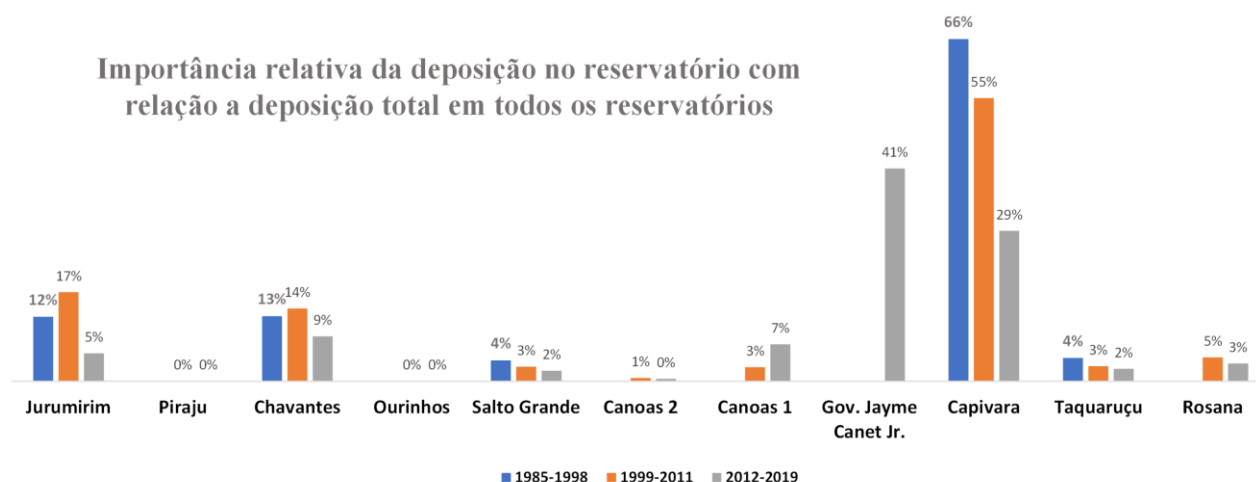
Figura 3 – Percentual de sedimentos depositado em um reservatório quando comparado com o total depositado em todos os outros. Os reservatórios que não apresentam dados em um determinado período não tinham sido ainda construídos.
