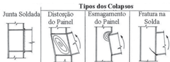
Figura 14 - Dependência da ductilidade em relação à importância do elemento na conexão [6].
