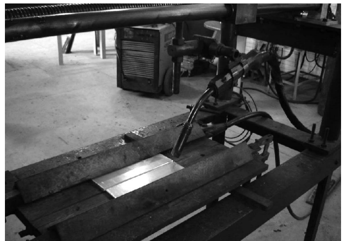
Figura 3. Dispositivo utilizado na soldagem MIG semi-automática.
