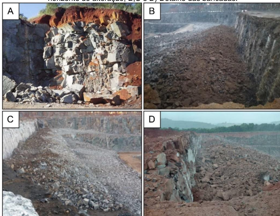
Figura 28 – Extração de basalto em pedreira. A) Maciço fraturado. Destaque para horizonte de alteração; B,C e D) Detalhe das bancadas.
