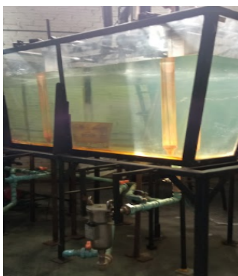
Figura 9 - Modelo físico do distribuidor do laboratório de siderurgia (Autor, 2022)
