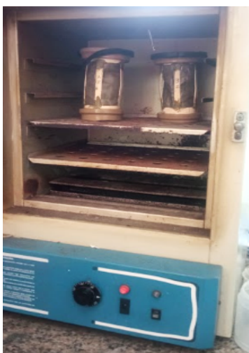
Figura 12 - Secagem de partículas passantes na estufa (Autor, 2022).
