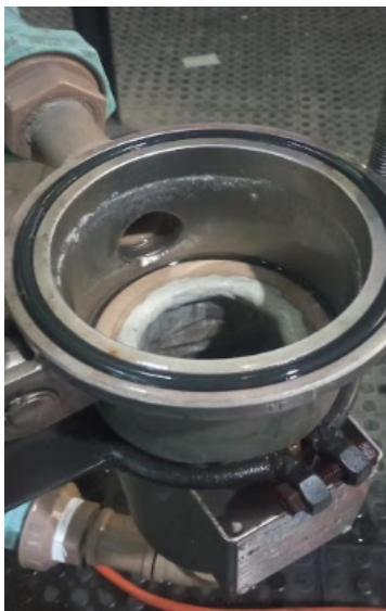
Figura 11 - Partículas passantes nos veios de saída do modelo físico do distribuidor (Autor, 2022).
