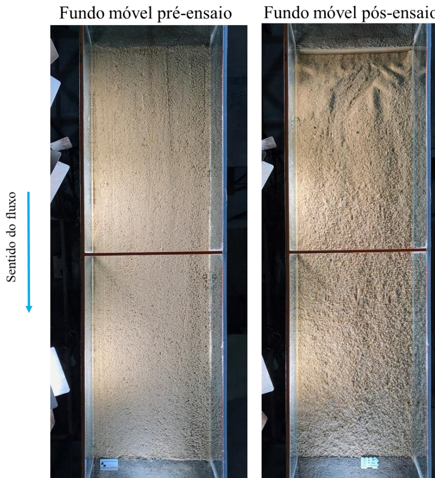
Figura 3 - Canal de fundo móvel: pré (plano inclinado e reguado) e pós ensaios (mudança na textura e caminhos preferenciais)
