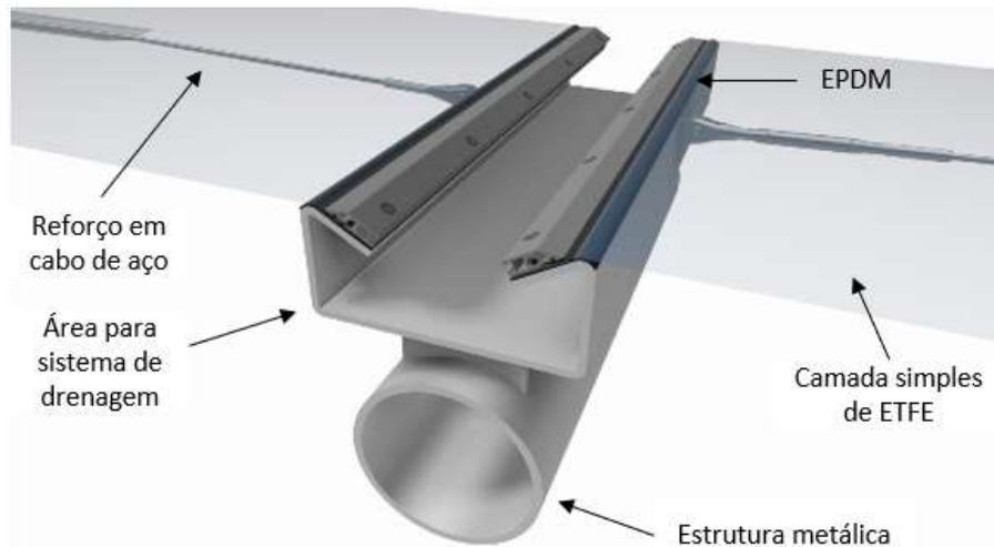
Figura 13: Estrutura de Camada Simples de ETFE
