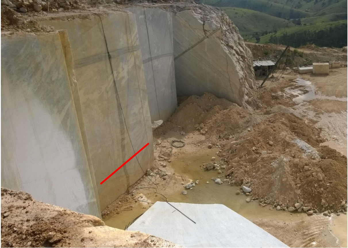
Figura 57 - Frente de extração da pedreira de rocha ornamental, onde pode ser observado a scanline em vermelho.
