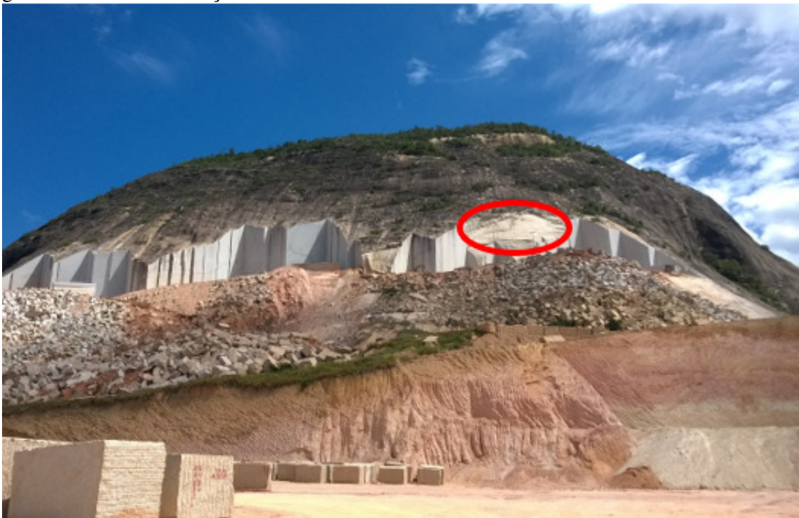
Figura 2 – Frente de extração com bancadas de alturas diferentes.
