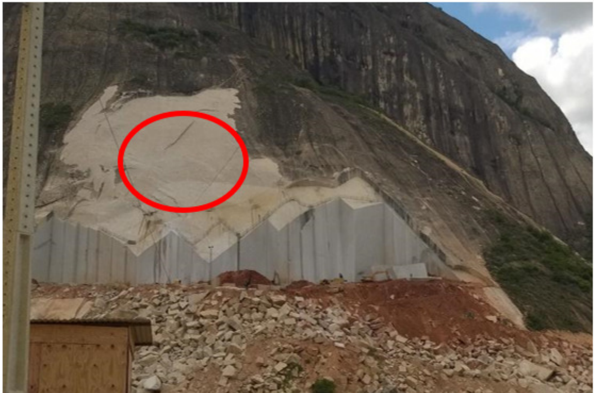
Figura 56 - Em vermelho, a região da descamação, onde foi necessário tratamento para evitar a queda do material.
