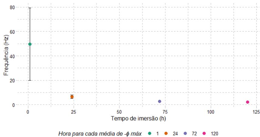
Figura 20 – Frequência para -\Phi_{max} . ( ^{\circ} ) por tempo de imersão, para o material ‘P’
