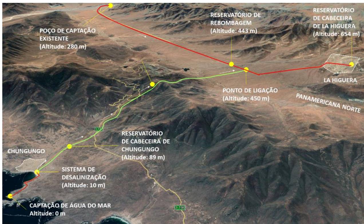
Figura 1: Esquema do sistema de abastecimento de água potável de Chungungo para La Higuera.
