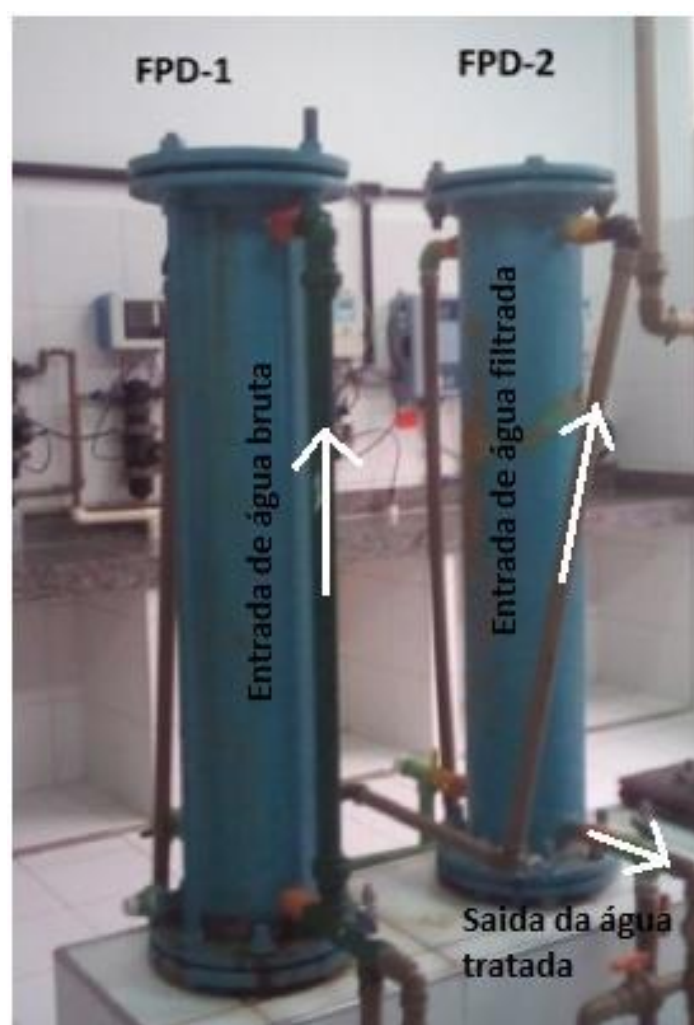
Figura 2- Sistema de dupla filtração modificada em escala piloto.
