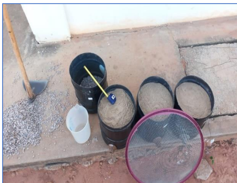
Figura 4: Confeção dos filtros em escala reduzida.
