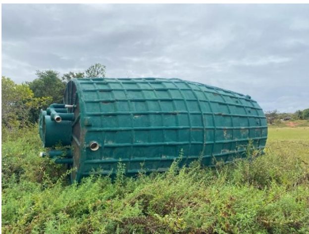
Figura 7 e 8: Equipamentos para tratamento de esgoto de Uiramutã em estado de abandono
