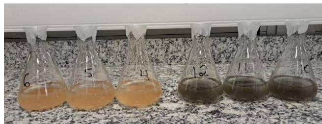
Figura 2: Erlenmeyer com lodo calcinado (à esquerda); e lodo seco (à direita).
