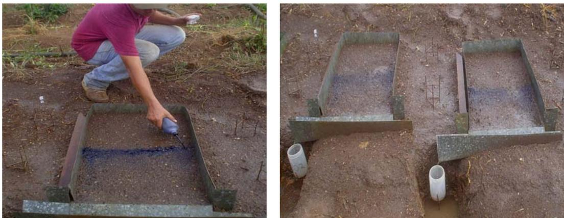
**Figura 8.** Medição da velocidade superficial do escoamento.
