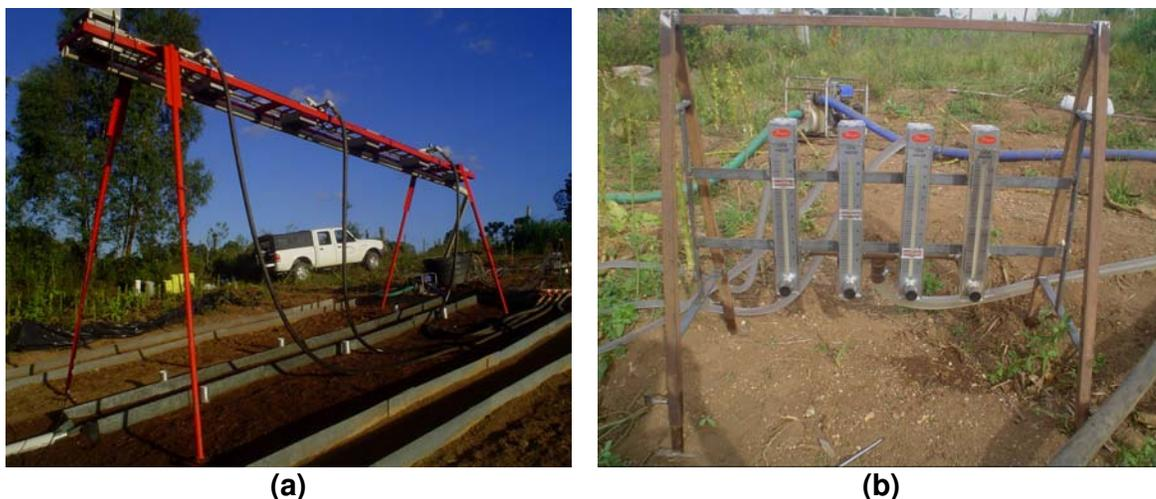
**Figura 10.** Aplicação de chuva simulada (a) e fluxos extras (b) em parcelas de erosão do solo em sulcos.
