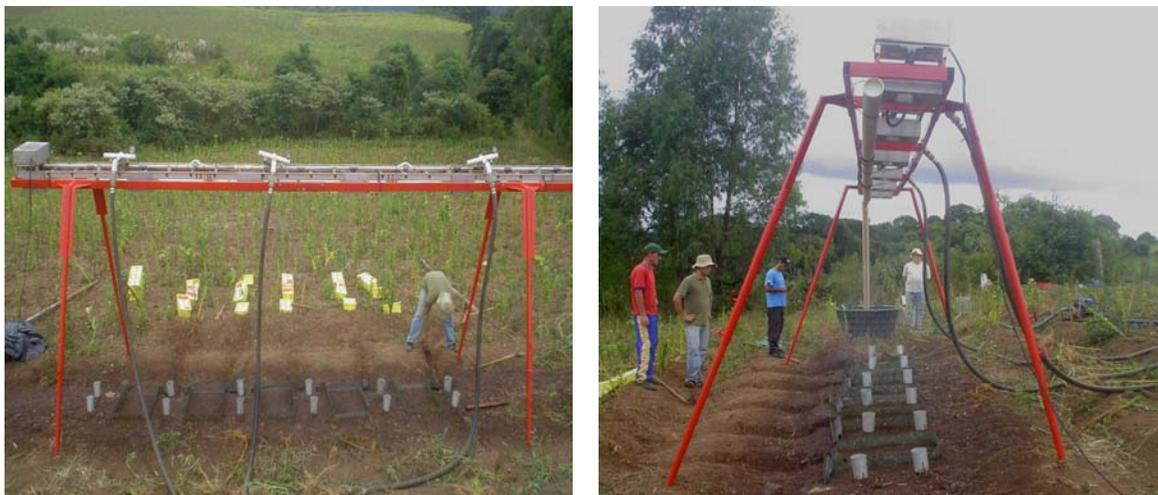
**Figura 7.** Aplicação de chuva simulada em parcelas de erosão do solo em entressulcos sob condição experimental de campo, utilizando um simulador de chuva.
