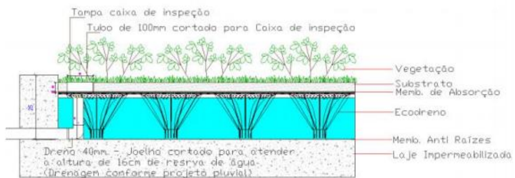
Figura 16 – Corte com detalhes do sistema Laminar Médio
