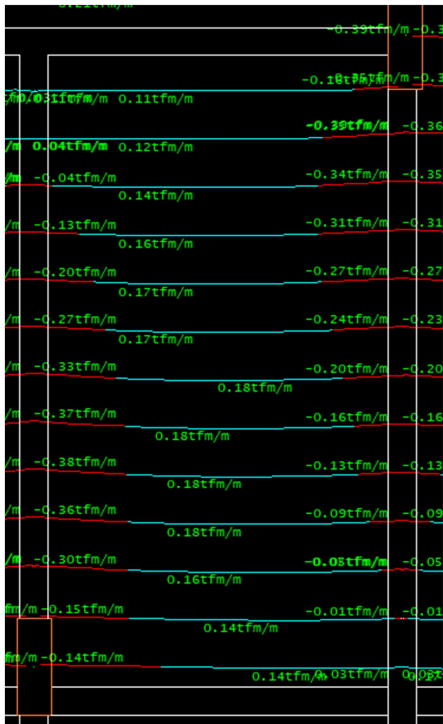
Figura 23 – Diagrama de momentos horizontais da laje 39 do TQS.
