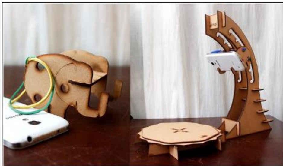
Figura 27: Suporte do smartphone e elásticos de segurança (esq) e estrutura completa montada com mesa giratória (dir)
