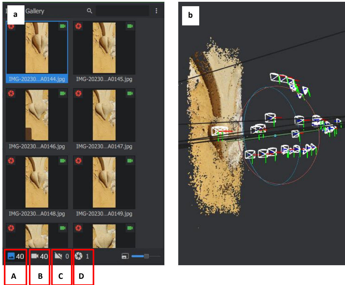
Figura 67: Software AliceVision Meshroom : (a) galeria de imagens importadas; (b) localização das câmeras de captura
