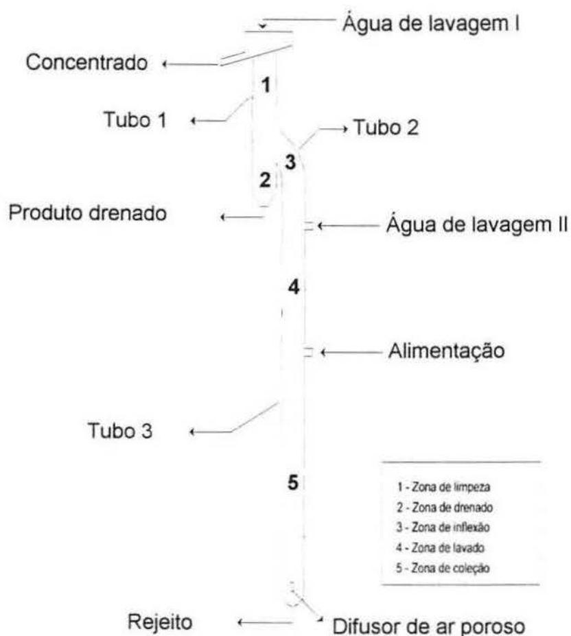
Figura 2.6. Coluna de flotação modificada de três produtos, C3P.
