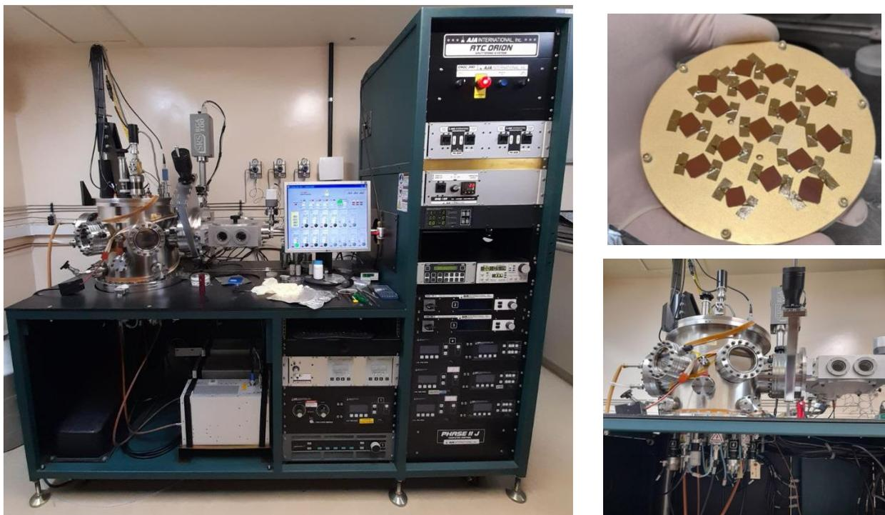
Esquerda equipamento completo com fontes de alimentação; direita superior substratos após *sputtering* de ouro e inferior os canhões. Fonte: Arquivo pessoal
