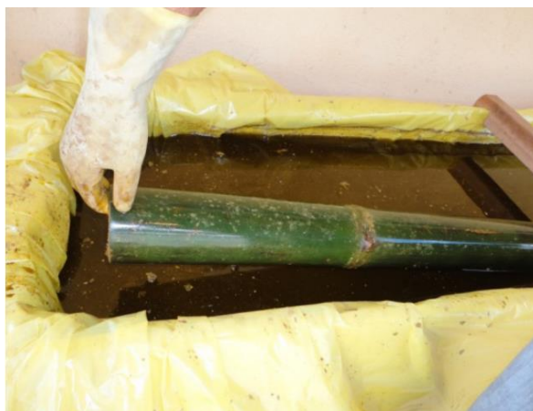
Figura 7- Bambu sendo tratado pelo processo de imersão em CCB
