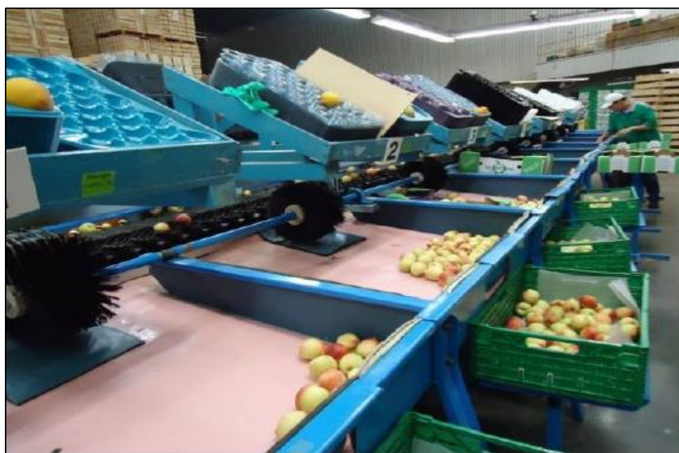
APÊNCICE B - Máquina eletrônica classificadora de frutos. Silvestrin Frutas, Farroupilha, RS. Fevereiro/2014.
