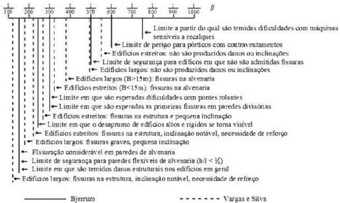
Figura 10 - limites de recalque diferencial específico em estruturas
