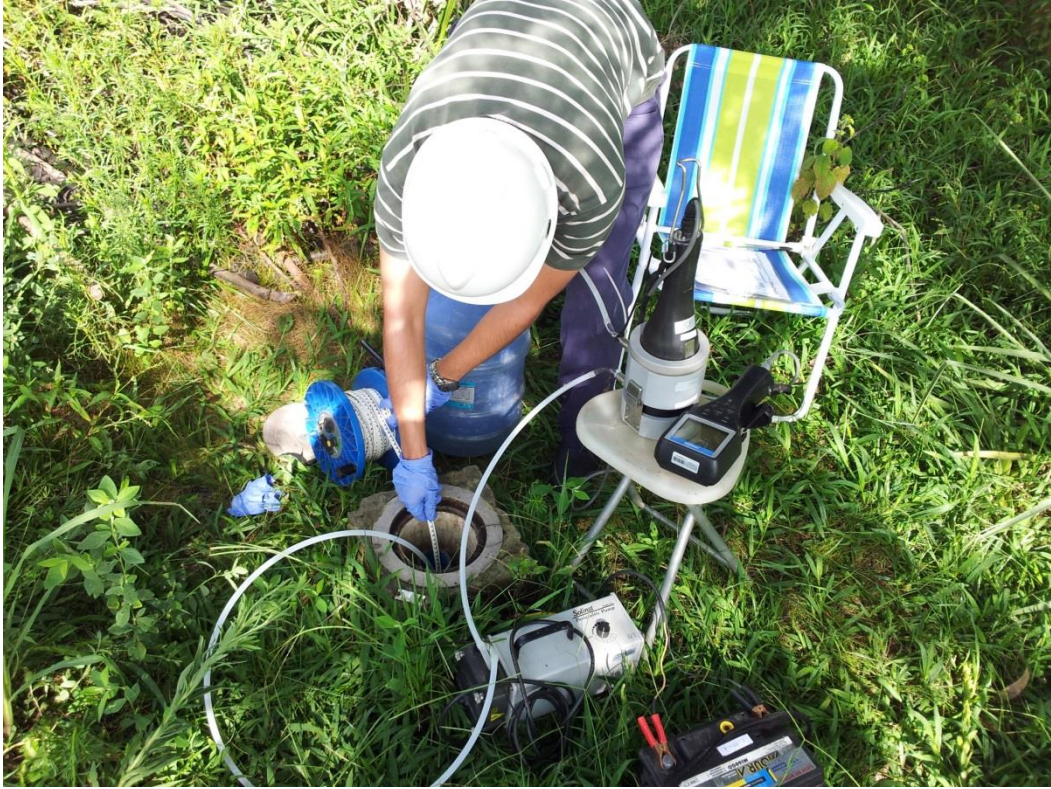
Figura 4 – Medição do nível de água no poço de monitoramento.
