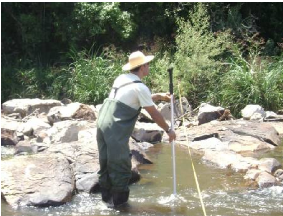
Figura 2- Aferição da vazão do Arroio Marrecas (Fonte: Polar – Inteligência em Meio Ambiente.)
