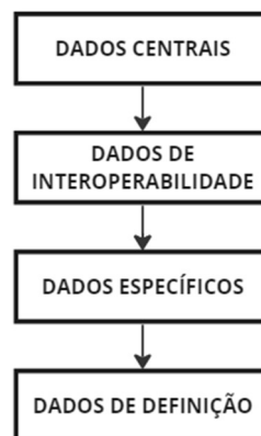
Figura 2 - Estrutura modular IFC
