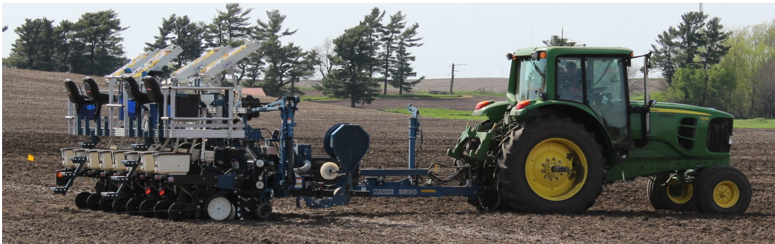
Figura 6 - Equipamento utilizado para o plantio de parcelas em experimentos.
