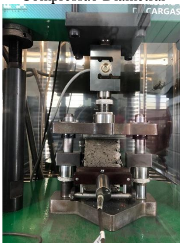
Figura 5 – Equipamento utilizado para ensaio de Módulo de Resiliência por Compressão Diametral
