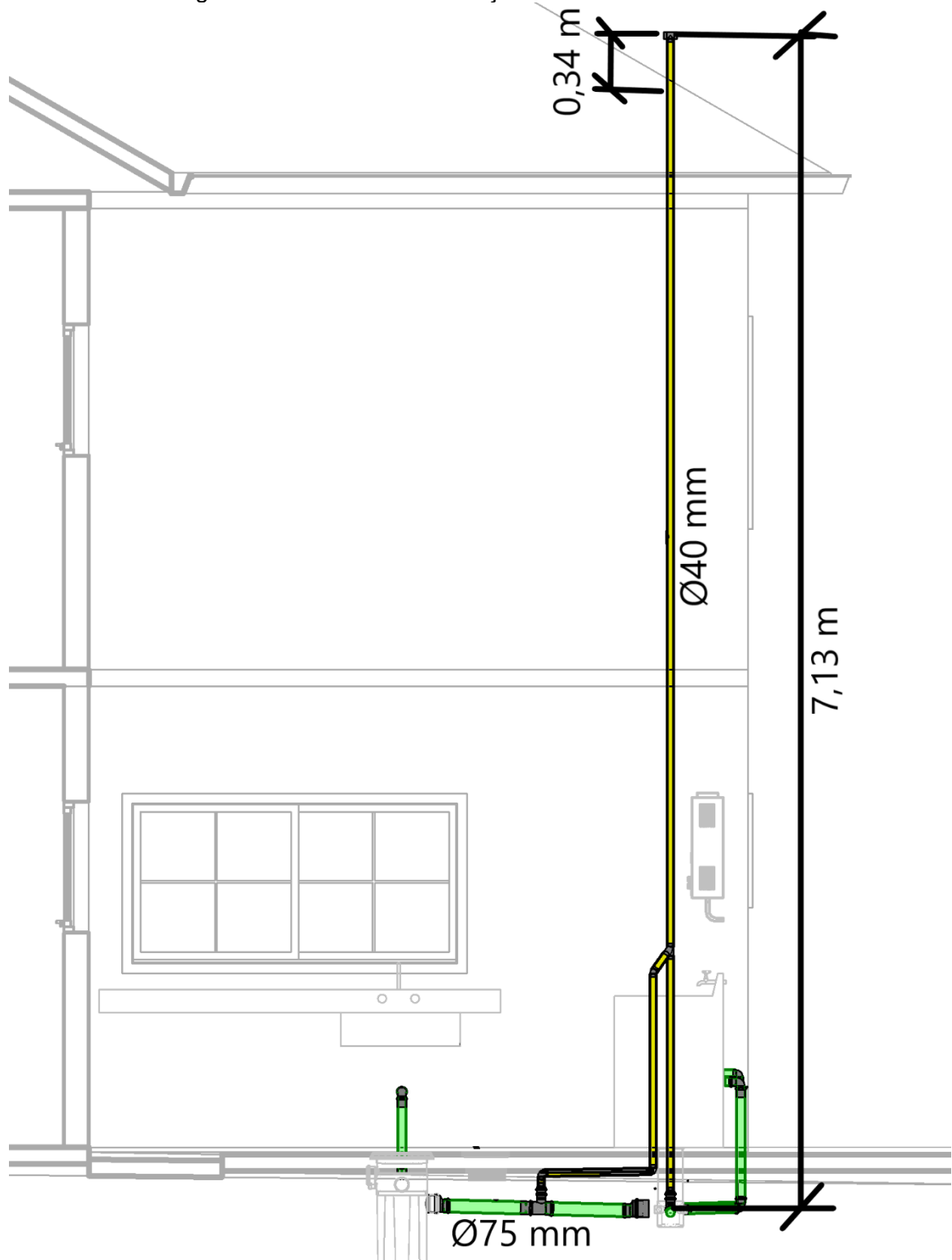
Figura 64 – Coluna de ventilação da cozinha e lavanderia
