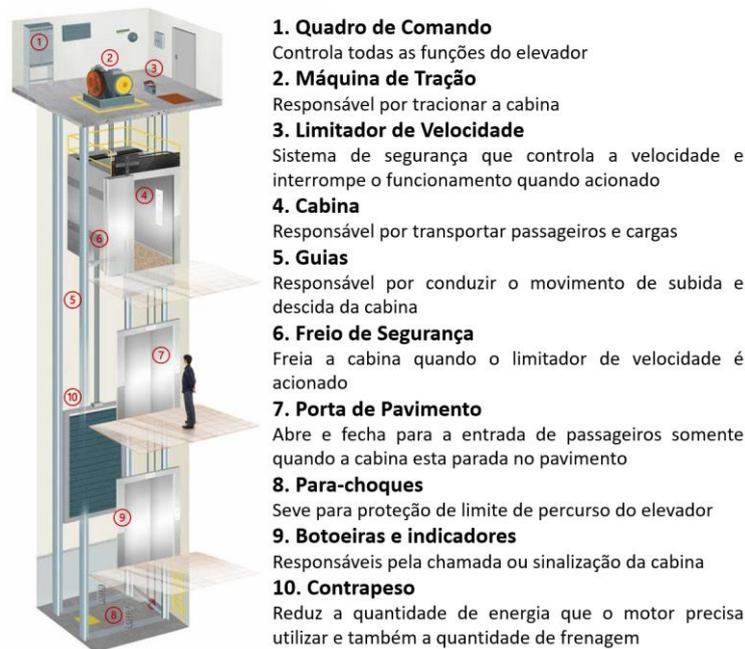
Figura 1. Elementos e funcionamento básico do elevador
