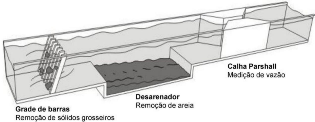
Figura 2 - Fases do tratamento preliminar com os objetivos de cada processo.
