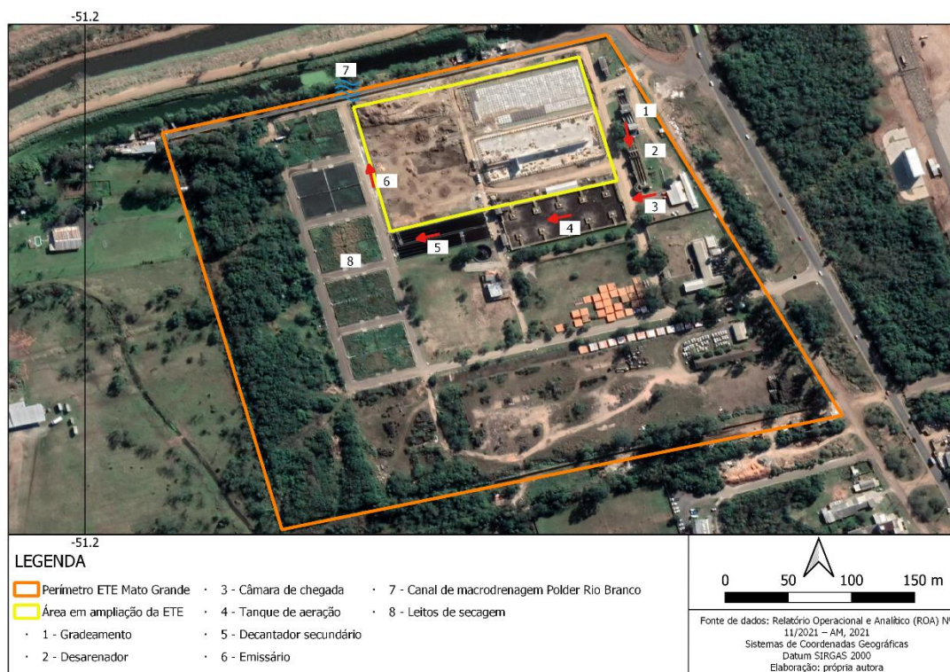
Figura 7 - Componentes do sistema de tratamento da ETE Mato Grande.
