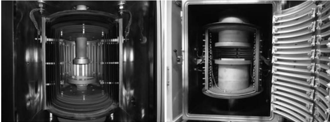
Figura 2.4-6 Exemplos de fornos para soldagem por difusão
