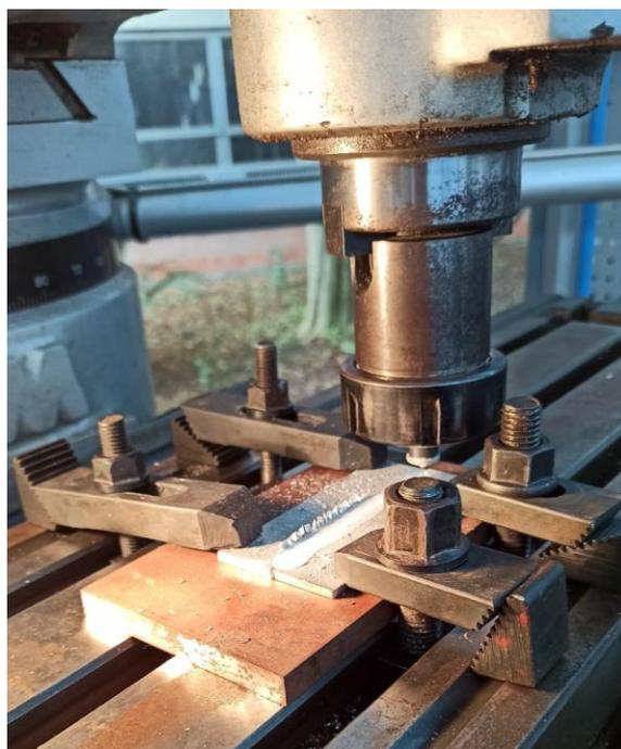
Figura 3.5-1 Sistema de fixação e bancada de soldagem
