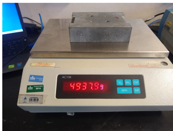
Figura 20: Bloco metálico utilizado no ajuste da célula de carga.
