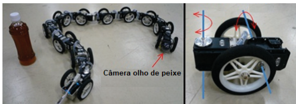
Figura 5: Robô snake com movimentação helicoidal.
