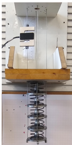
Figura 2: Robô snake em bancada utilizado para testes.
