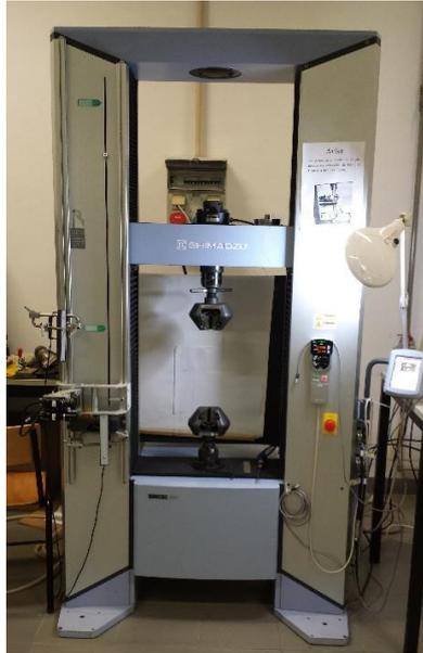
**Figura 19.** Máquina Universal de ensaios Shimadzu AG-x 250kN
