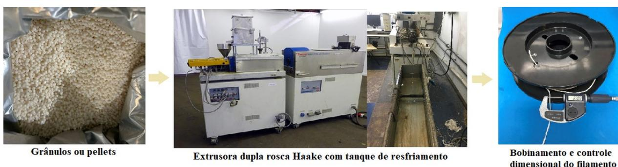
**Figura 11.** Processo de fabricação de filamentos de PBAT para impressão 3D.
