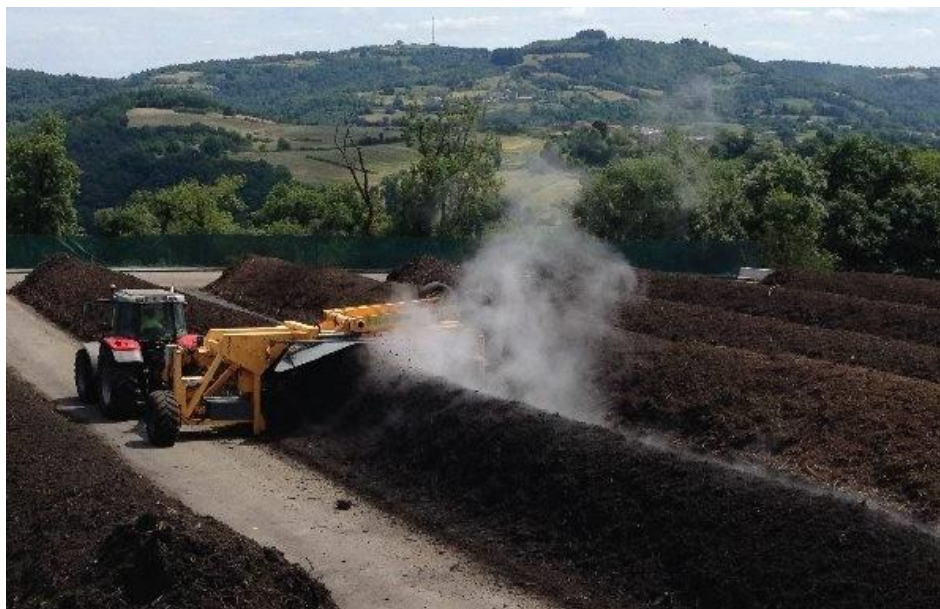
Figura 5 - Exemplo de máquina com revolvedor de leiras (Maquina Solo, 2021)
