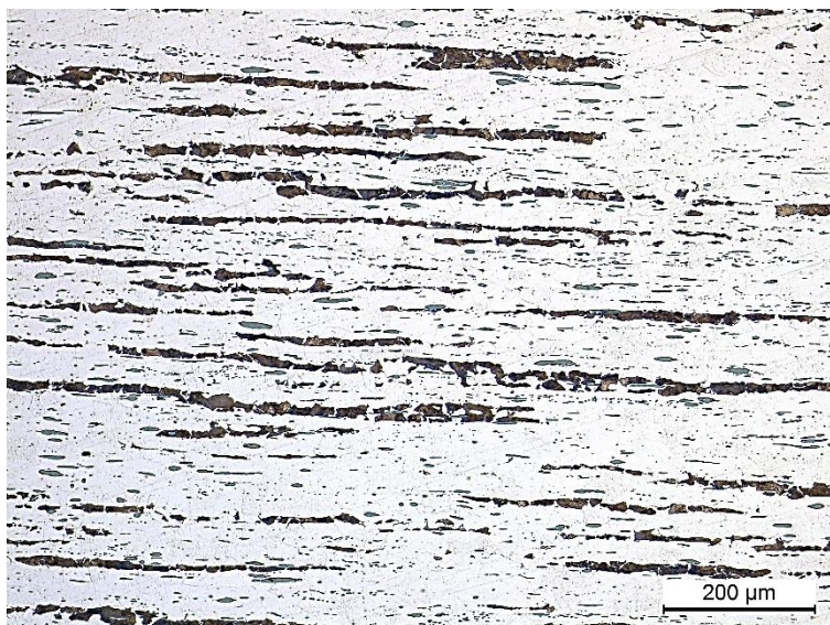
Figura 5.10: Amostra nova em aço ao carbono, com 100 vezes de aumento: Matriz ferrítica (branco) e perlita (escuro).
