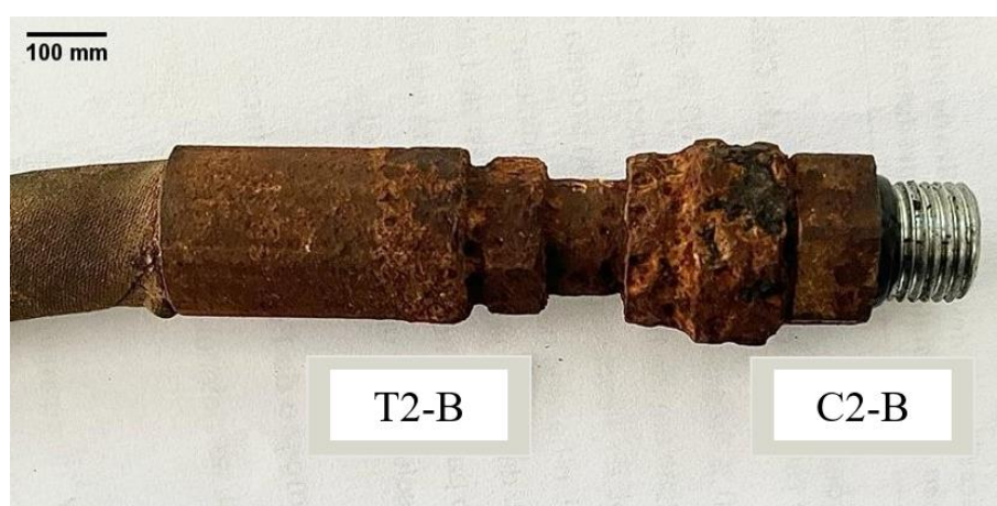
Figura 4.6: Amostra 02 subdividida em C2-B e T2-B, conforme nomenclatura utilizada. Fonte: Autor, 2023.
