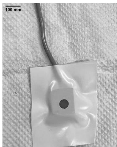
Figura 4.7: Instrumentação utilizando fita galvânica, com um d=6,5 \text{ mm} na área exposta. Fonte: Autor, 2023.
