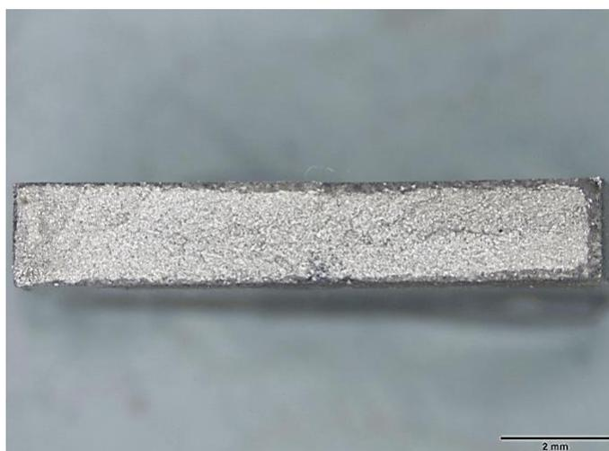
Figura 36 Macrografia em lupa mostrando a fratura da amostra tratada termicamente em banho de sais.
