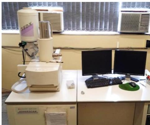
Figura 23 Microscópio eletrônico de varredura (MEV), modelo Shimadzu SSX-550.
