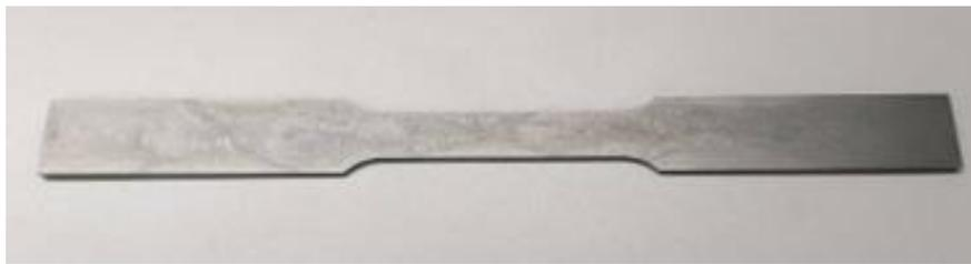
Figura 20 CP confeccionado para ensaio de tração.
