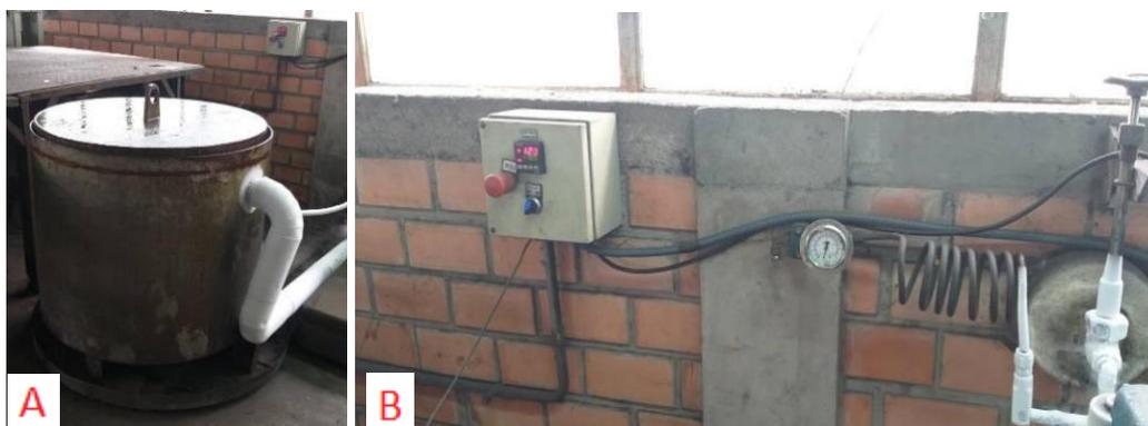
Figura 16 (A) Câmara de resfriamento subzero; (B) Detalhe do sistema de controle da válvula reguladora de pressão.
