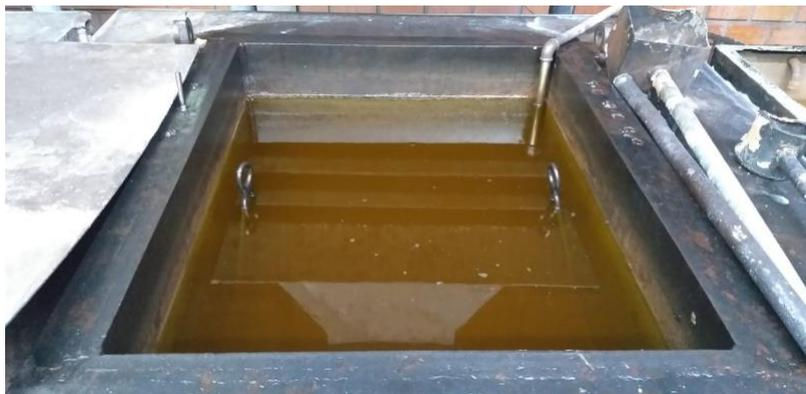
Figura 17 Tanque de banho de sal para a realização do tratamento térmico de Revenimento.
