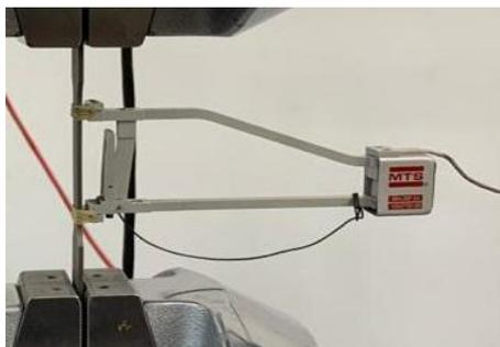
Figura 21 Extensômetro utilizado para a medição do alongamento ( $\delta$ ).
