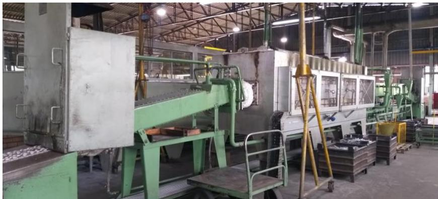
Figura 15 Equipamento utilizado para o tratamento térmico em forno contínuo.
