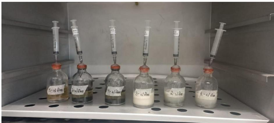
**Figura 6.** Biorreatores após os 60 dias de incubação.
