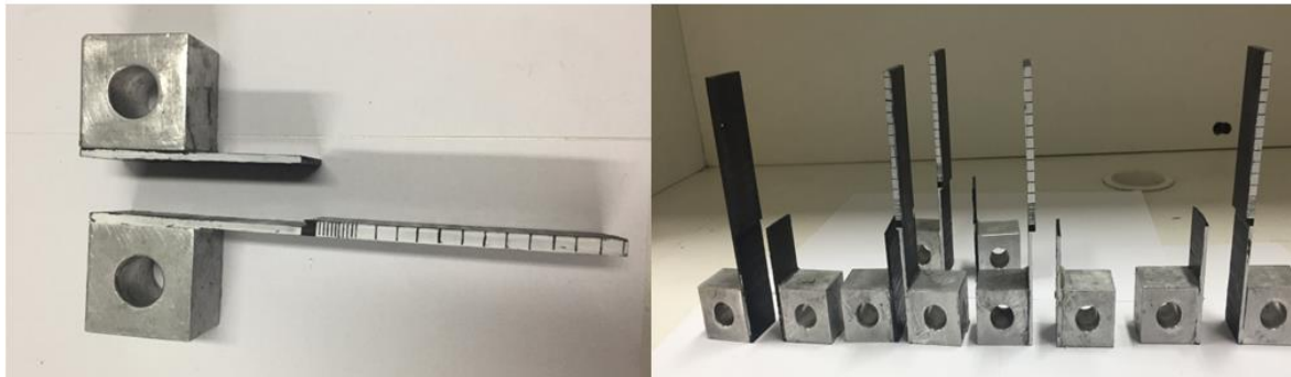
Figura 29. Amostras DCB 90° fraturadas por flexão devido à pouca resistência do laminado a essa condição de carregamento
