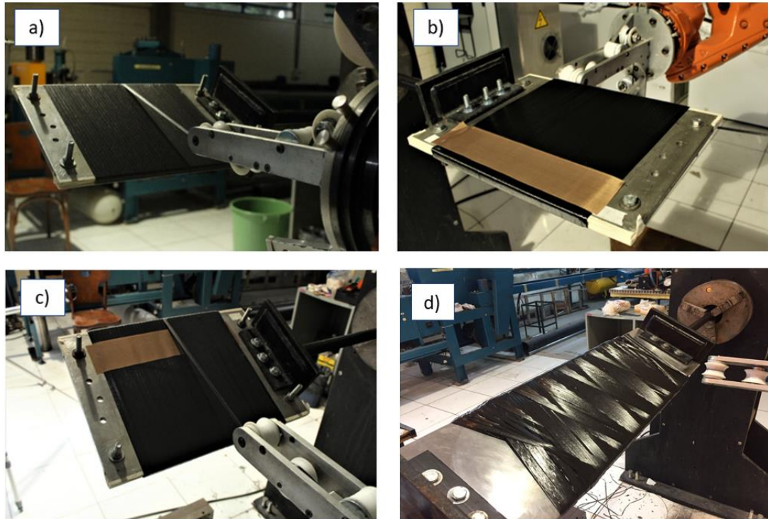
Figura 11. Etapas do enrolamento filamento para obtenção dos laminados para os ensaios DCB e ENF: (a) enrolamento de 8 camadas, (b) aplicação do filme de teflon e (c) enrolamento de mais 8 camadas, (d) enrolamento angulado
