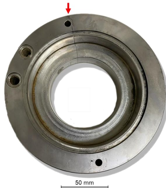
Figura 4 – Prato 3 como recebido, seta em vermelho indicando a trinca no componente (Fonte: a Autora, 2023)
