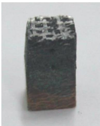
Figura 4 - Resina de sílica fenólica após o processo de ablação (SHENGBO, 2012)
