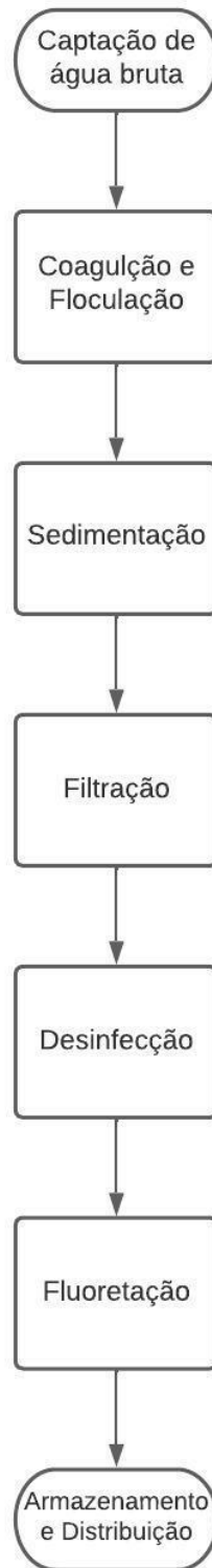
Figura 1 - Fluxograma simplificado para estações de tratamento de águas
