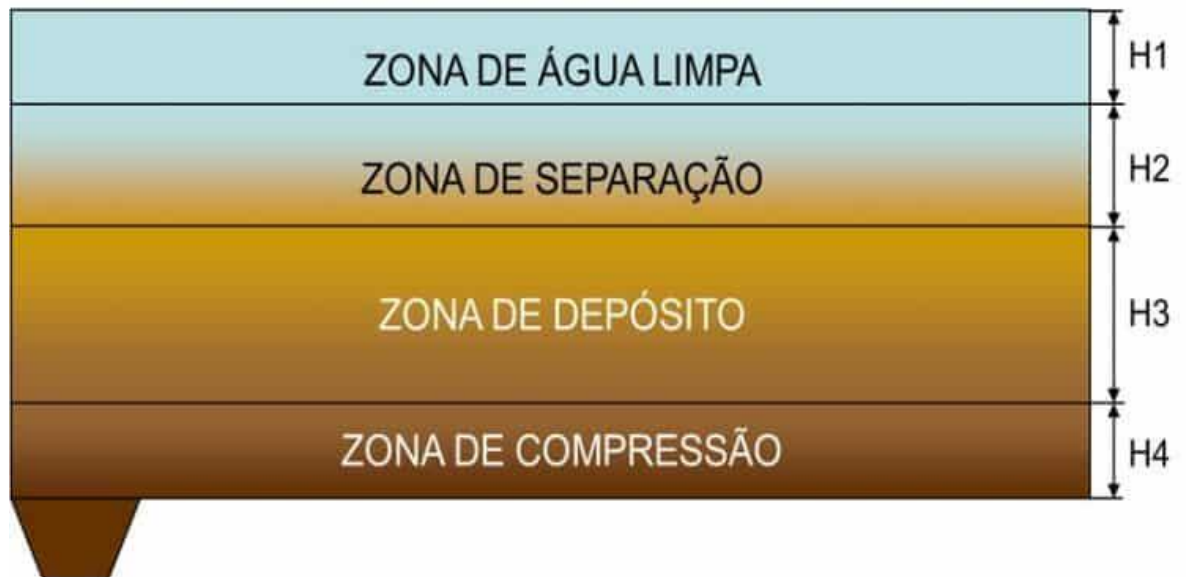
Figura 2 - Zonas observadas em decantadores convencionais
