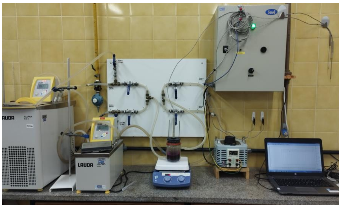
Figura 9 – Sistema de aquecimento ôhmico utilizado no ICTA / UFRGS.
