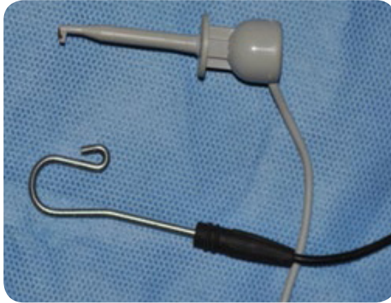
Figura 6 - Presilha do eletrodo (acima) e alça labial (abaixo) conectadas ao aparelho. (Imagem dos autores)
