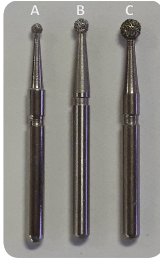
Figura 14 - Pontas esféricas diamantadas haste curta #1012 (A), #1014 (B) e #1016 (C). (Imagem dos autores)
