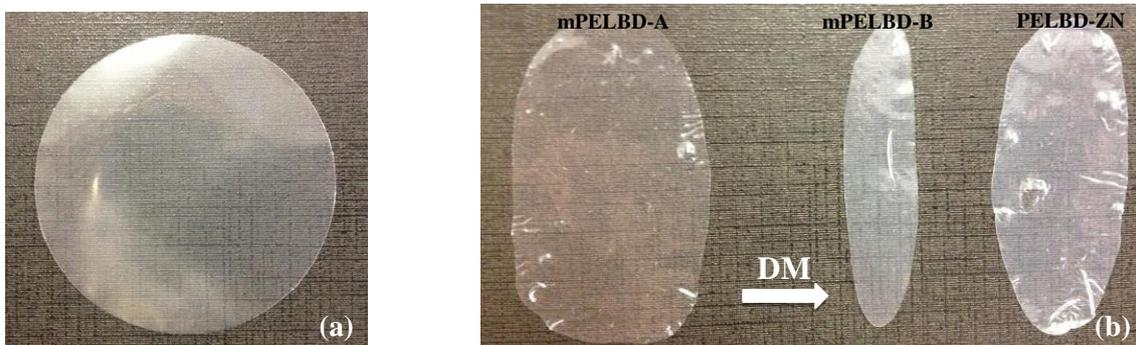
Figura 1: Corpos de ensaio antes (a) e após (b) o ensaio de encolhimento.
