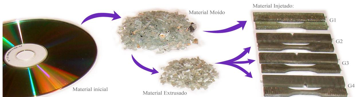
**Figura 2. Representação esquemática da obtenção dos corpos de prova.**
