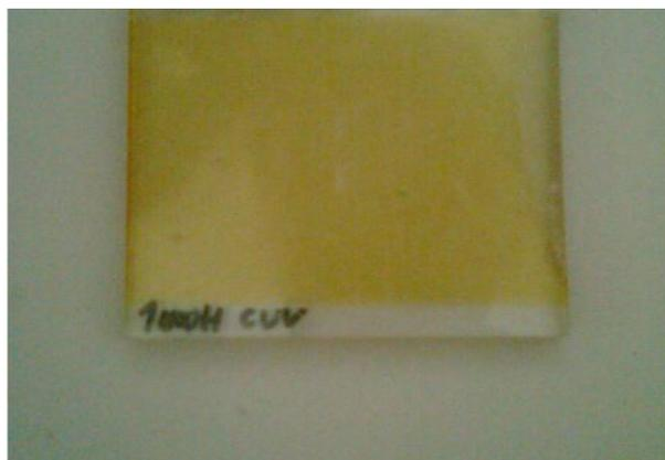
**Figura 2.** Corpo de prova equivalente a 12 meses em intemperismo.
